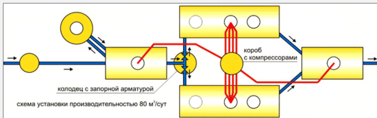
Производительность установок ЭКО-Р составляет от 3 до 3000 куб.м/сут. Установки ЭКО-Р изготавливаются в соответствии с ТУ 4859–001–48117609–06 на основе емкостей из стеклопластика, являющихся основой строительной конструкцией, принимающей на себя всю нагрузку от грунта, грунтовых вод, снега и т.д. Срок службы стеклопластиковых изделий – не менее 50 лет.
